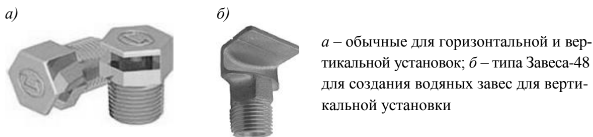
Рисунок 7.5 – Противопожарные дренчерные оросители
