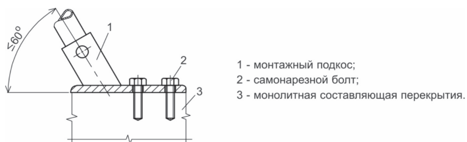
Рисунок Д.3 – Крепление монтажного подкоса стенового элемента к перекрытию
