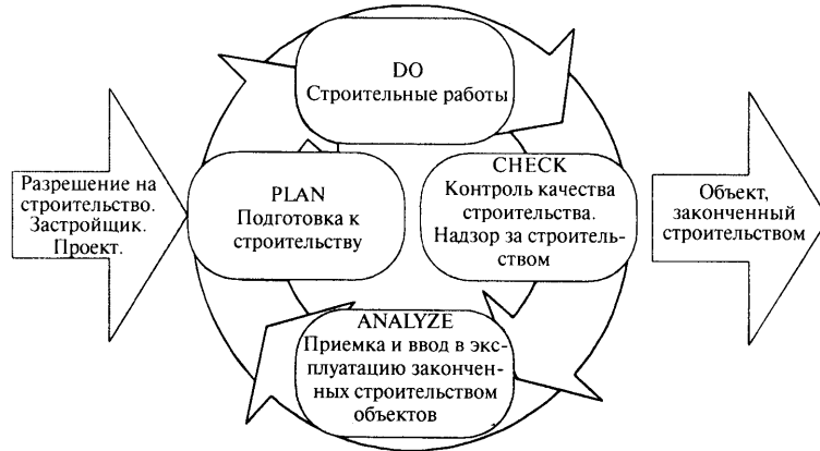
Г.2 Пример схемы взаимодействия процессов строительной организации
